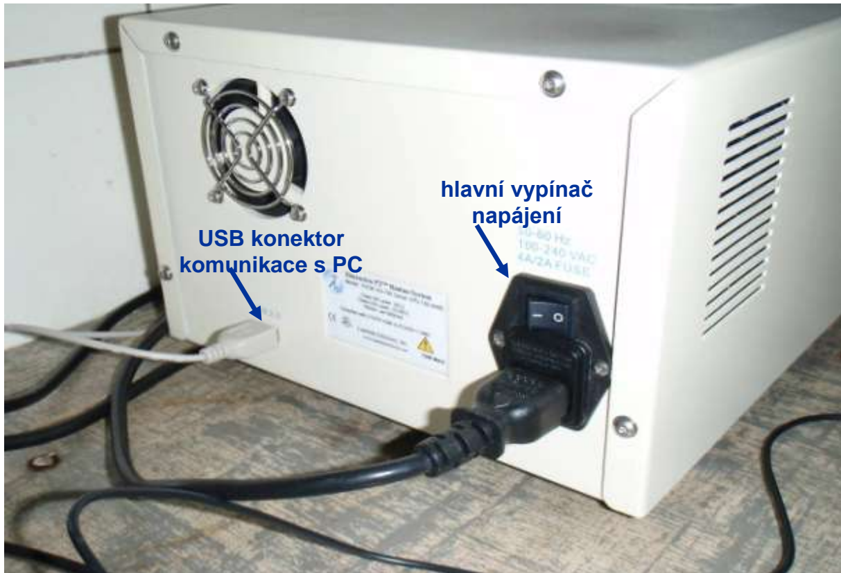
Obr. 2 Pohled na zadní stěnu spektrometru Dimension-P2
