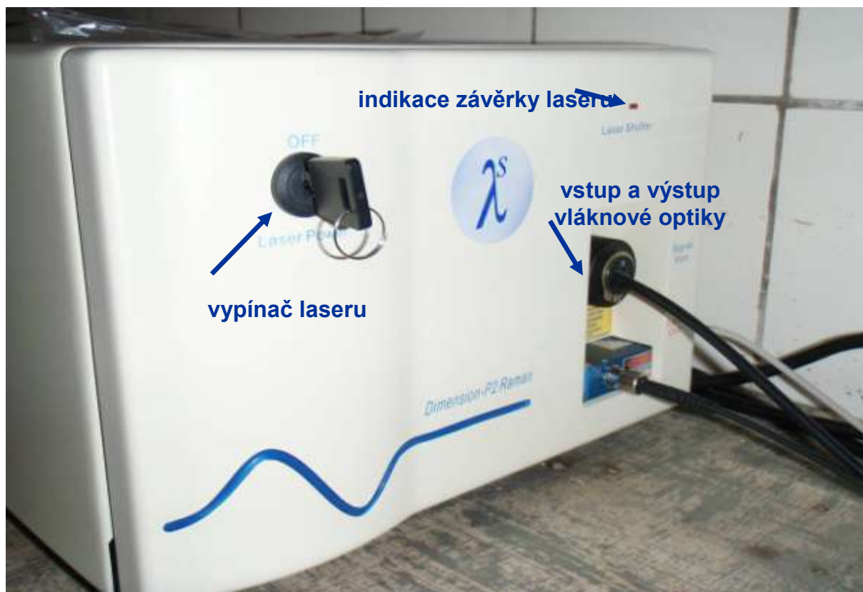
Obr. 3 Pohled na přední stěnu spektrometru Dimension-P2
