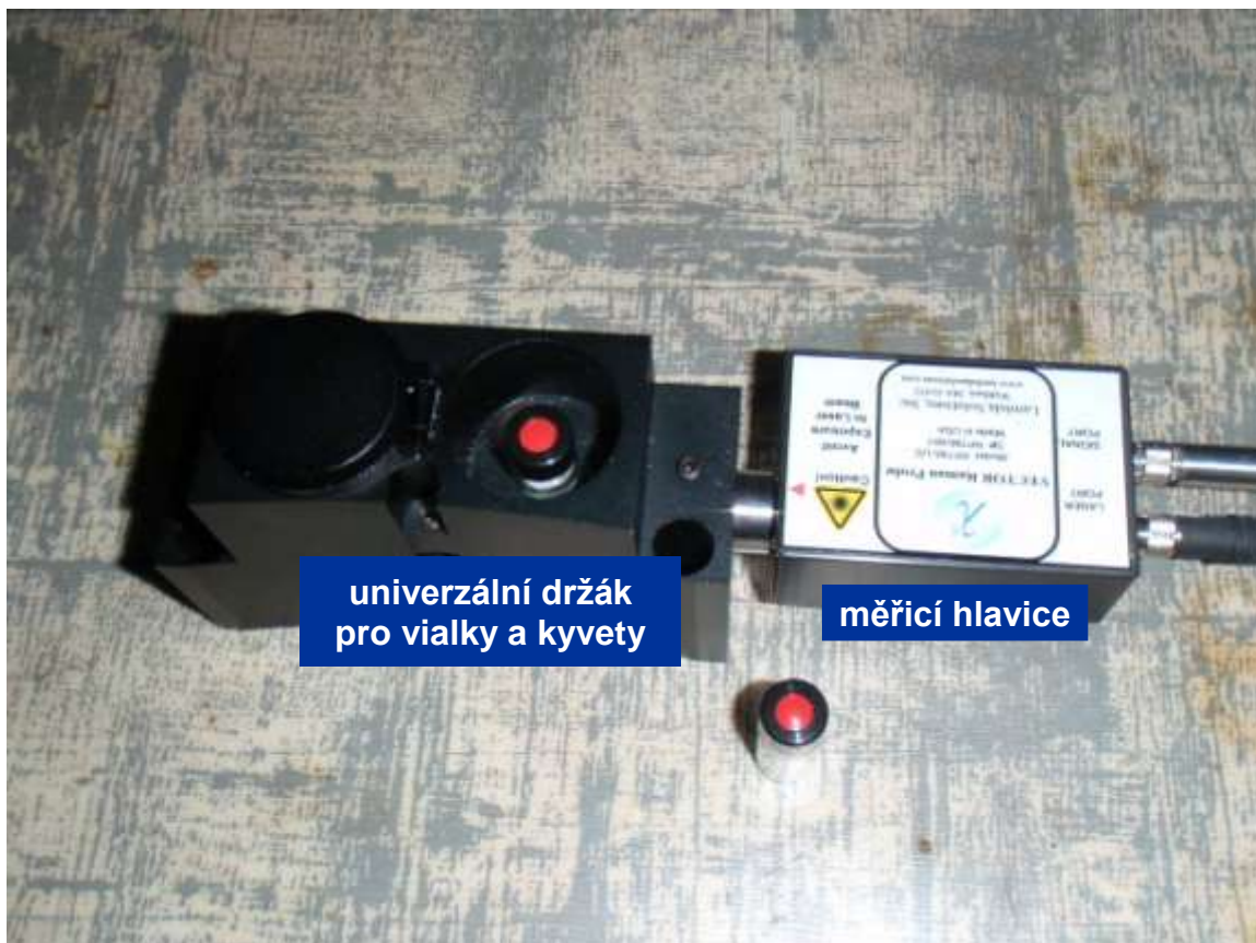
Obr. 4 Měřicí sonda umístěná v univerzálním držáku vzorků
