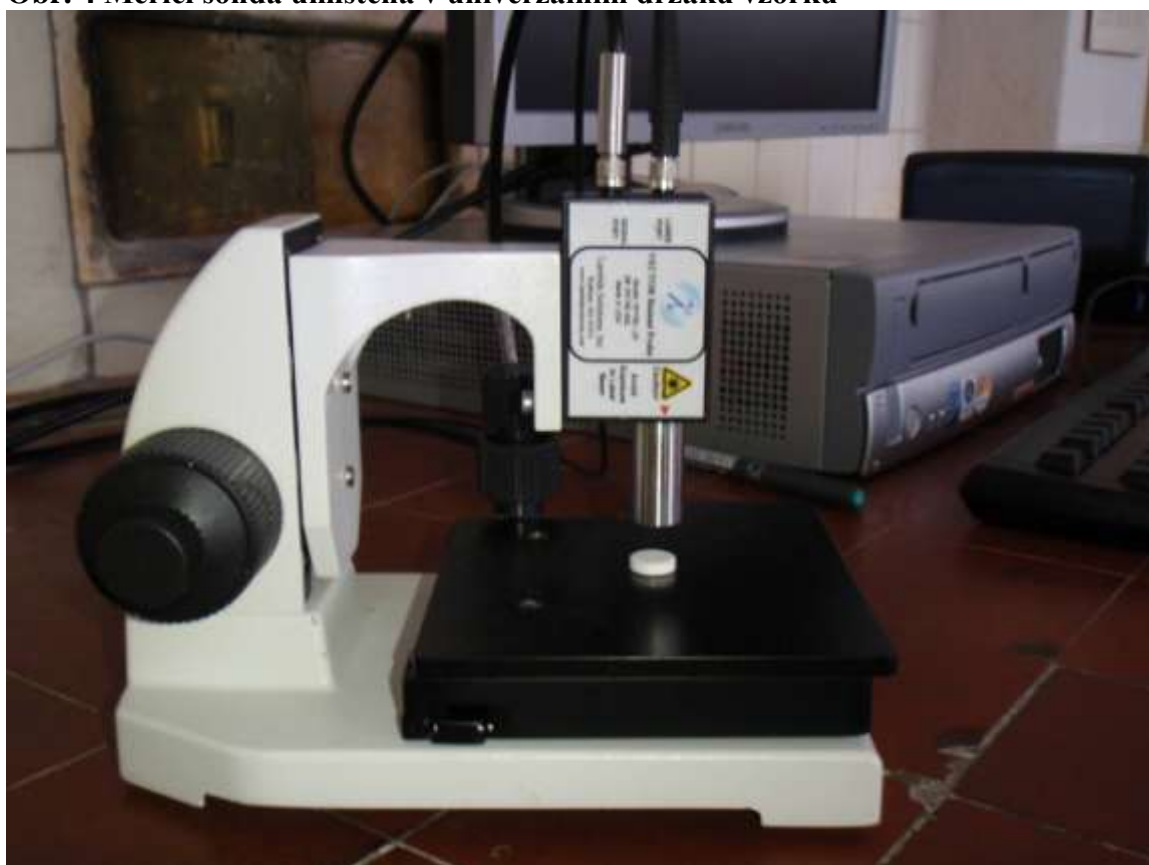
Obr. 5 Měřicí sonda fixovaná k x-y-z polohovacímu zařízení
