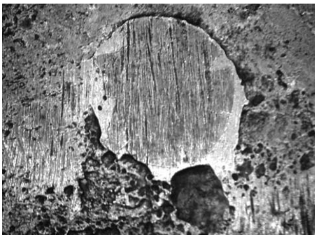
Obr.7. Detail nýtového spoje zlomené čepel
