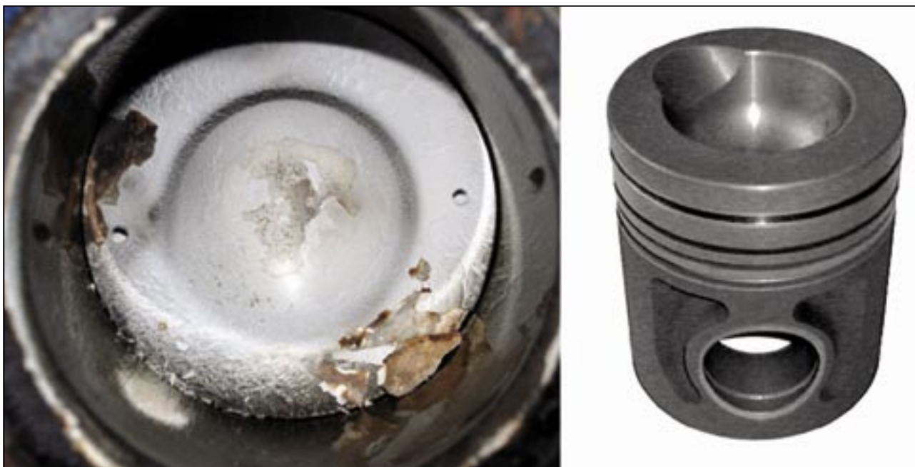
Obr. 4 Nápeky \text{SiO}_2 na stěně pístu motoru po cca. 5000 hod. provozu a nový píst
