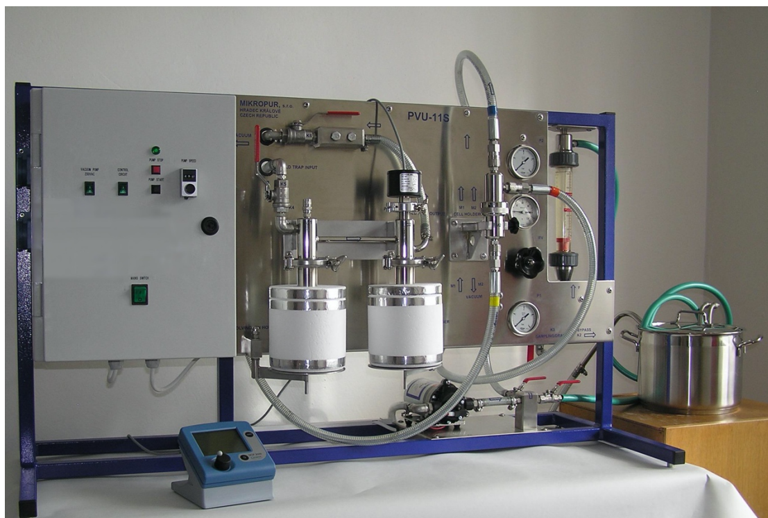
Obr. 2. Příklad pervaporační jednotky od firmy Mikropur s.r.o.
