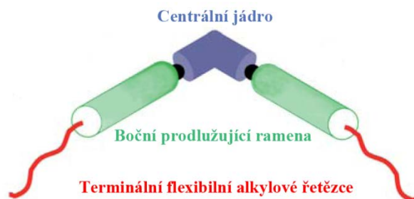
Obrázek 7 Obecná struktura lomeného kapalného krystalu.
