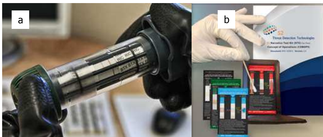
Obr. 14: a) IMASS pro odhalení přítomnosti biologické hrozby, b) souprava pro detekci narkotik (vpravo). Převzato z http://www.bbidetection.com/products/ , III/2017
