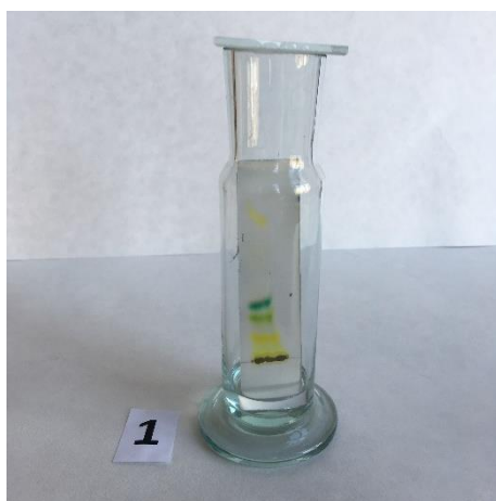
Obrázek 2: Chromatografická komora (vzestupné vyvíjení)
