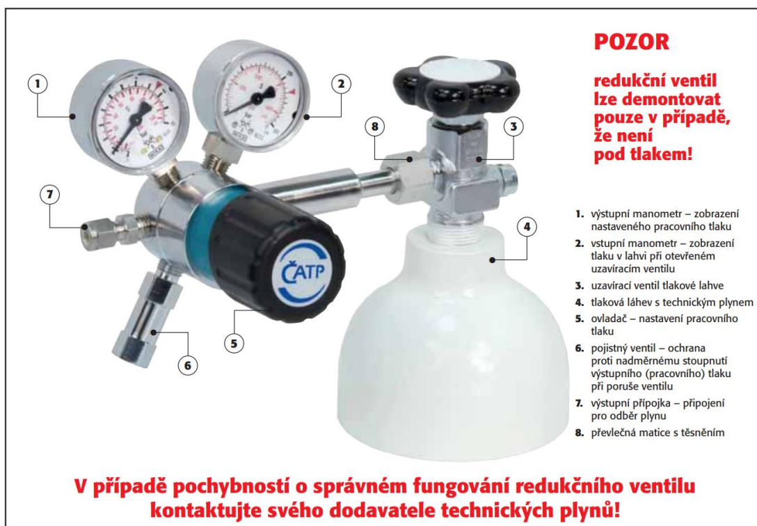
Obrázek č. 14: Popis redukčního ventilu (Česká asociace technických plynů)
